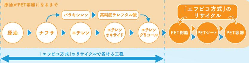
食品トレーの素材となる原料を作る工程ではたくさんの二酸化炭素(CO<sub>2</sub>)が排出されます。「エコAPET®」はその工程が省ける環境負荷の少ないエコな素材です。
